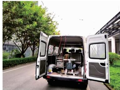
图 5 导航系统与标准惯导跑车试验照片
