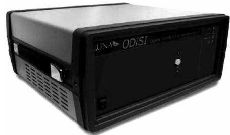
图 8 ODiSI-A50 光纤解调仪
