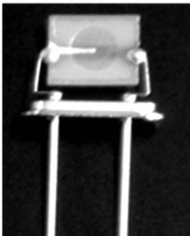
图 2 离子刻蚀工艺加工的晶体谐振器
