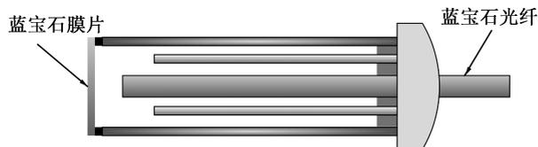
图7 传感器结构示意图
