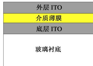
图1 ITO/介质薄膜/ITO实验样品结构示意图
